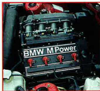
De röda tändhattarna avslöjar den 2.467 cc stora Evolution-motorn som utvecklar 238 hk vid 7.000 rpm.
