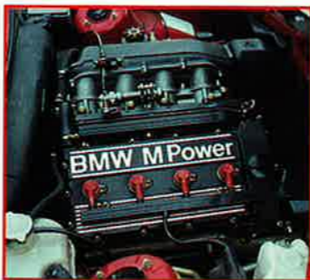
De röda tändhattarna avslöjar den 2.467 cc stora Evolution-motorn som utvecklats till 238 hk vid 7.000 rpm.
