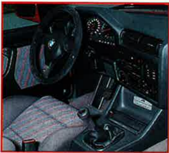
Perfekt instrumentering, greppvänlig mockaratt och mockadverdragen växelspaksknopp som är belyst inifrån.
